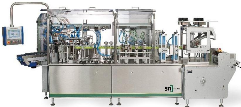
Die SN Deutsche Beutelpack-Technik zeigt auf der FachPack 2018 eine intermittierend arbeitende, horizontale Rundläufermaschine FM 060 bei der Verarbeitung von BarrierPack Recyclable zu Form-, Füll- und Siegelverpackungen (FFS). (Foto: Mondi, PR101)
